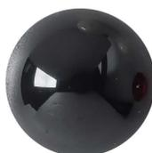
Unsere Taster der Reihe **UltraScanning** bestehen aus einer Siliziumkarbidkugel, deren Oberfläche mit einer **Diamantschicht von etwa 0,03 mm** überzogen ist. Fremdmaterialien bleiben auf der Kugel nicht haften, Materialreste lassen sich einfach abwischen.
