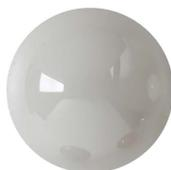
Dies ist der am **häufigsten eingesetzte** keramische Hochleistungswerkstoff. Er besitzt eine **sehr hohe Härte** und seine Anwendungsgebiete sind vergleichbar mit denen des Zirkonoxid.
